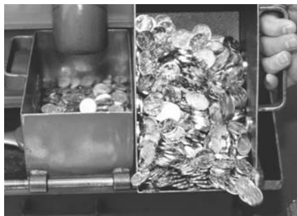
Vyústění dráhy, po které hotová mince opouští lis a přesypávání mincí do kontejneru.
