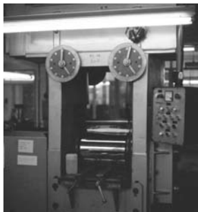
Válcovací stroj na válcování cánů z drahých kovů do hladka v Allgemeine Gold- und Silberscheideanstalt.
