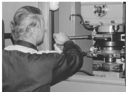
Ražební prostor lisu s kruhem při zakládání razidel.
